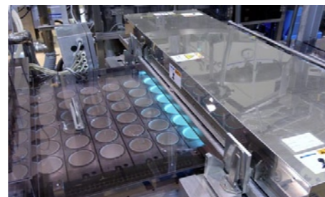
充填前の容器の表面殺菌 高出力表面殺菌装置400W×6灯用
