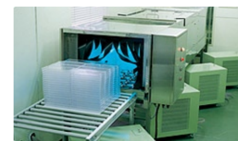
充填室搬入前の容器の包装物の殺菌 高出力表面殺菌装置200W3灯用×4台
