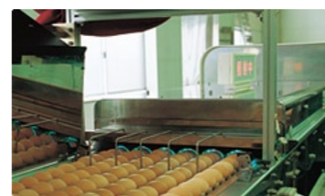
タマゴの表面殺菌 中出力表面殺菌装置(65W×7灯用 特注照射器)
